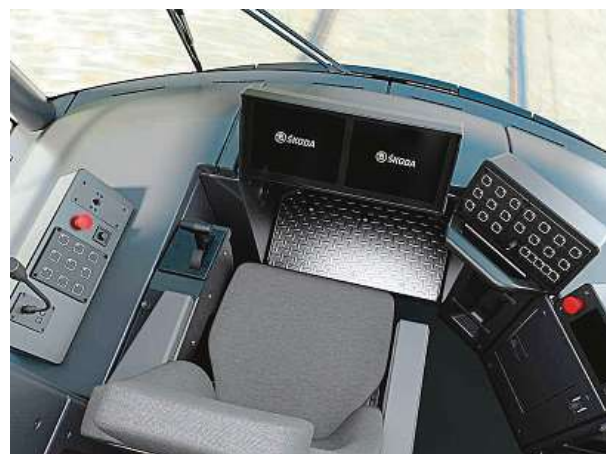
I řidičům se díky novým tramvajím změní život. Panel v kabině řidiče je nově rozdělen na tři samostatné části.
