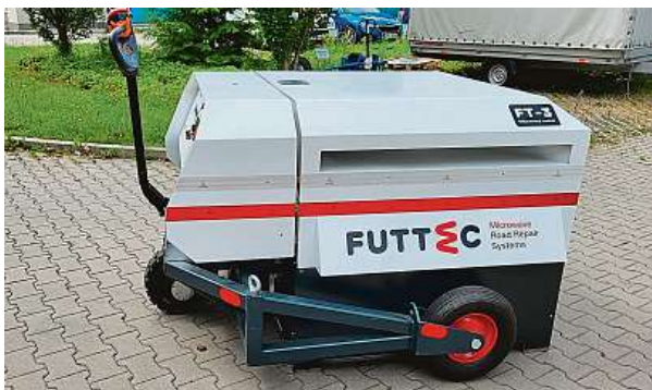
Systém preventivních oprav výtluků pomocí mikrovln je určený k celoročním opravám silnic, cyklostezek či parkovišť. 3x FUTTEC
