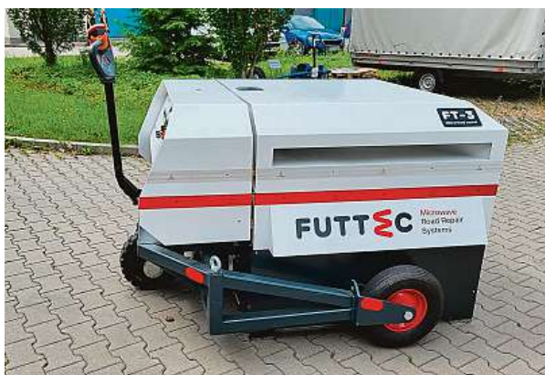
Systém preventivních oprav výtluků pomocí mikrovln je určený k celoročním opravám silnic, cyklostezek či parkovišť. 3x FUTTEC
