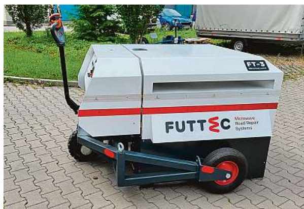
Systém preventivních oprav výtluků pomocí mikrovln je určený k celoročním opravám silnic, cyklostezek či parkovišť.
