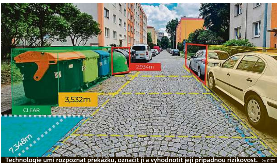
Technologie umí rozpoznat překážku, označit ji a vyhodnotit její případnou rizikovitost. 2x OICT
