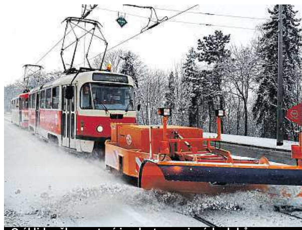
O úklid sněhu se stará i sedm tramvajových pluhů. ADPP
