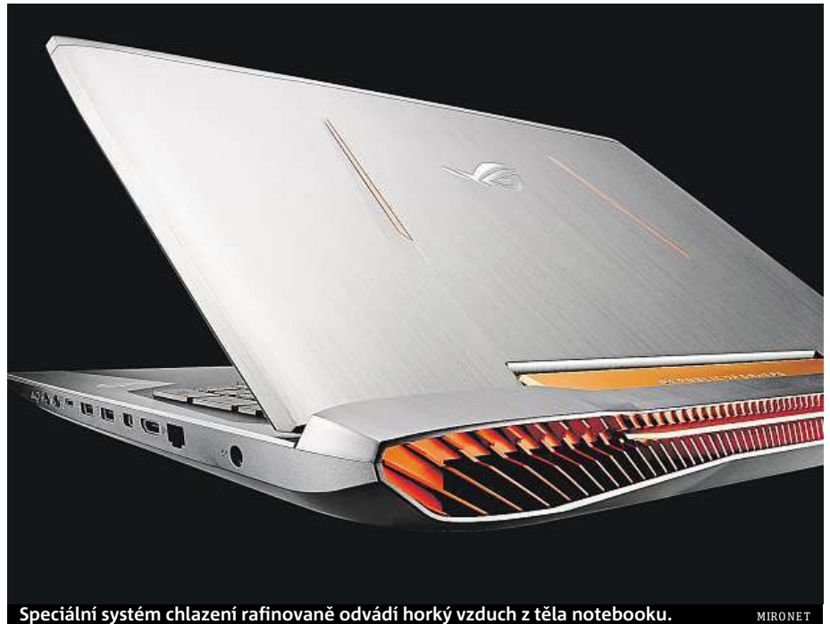
Speciální systém chlazení rafinovaně odvádí horký vzduch z těla notebooku.
