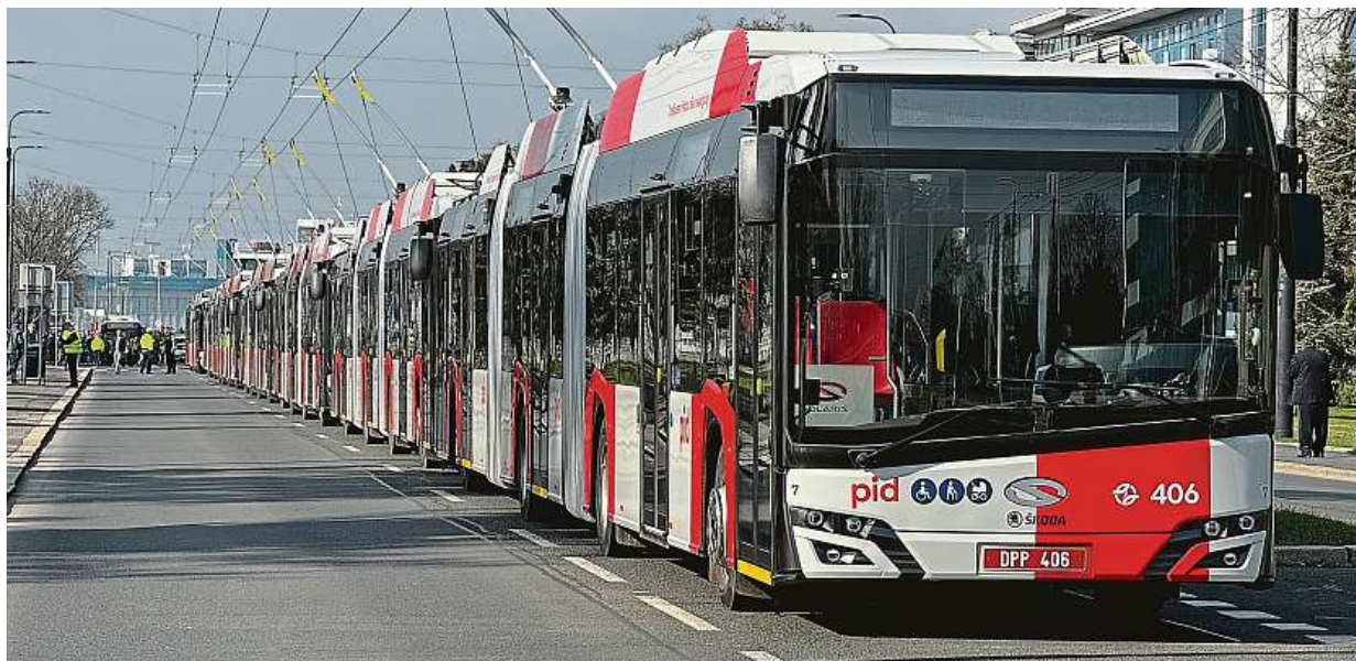
Trolejbusy Škoda-Solaris 24m nahradily autobusy SOR NB18. Pro zajištění provozu trolejbusů bylo vybudováno celkem 11,5 kilometru trolejového vedení v úseku Nádraží Veveřslavín a Terminál 3.
