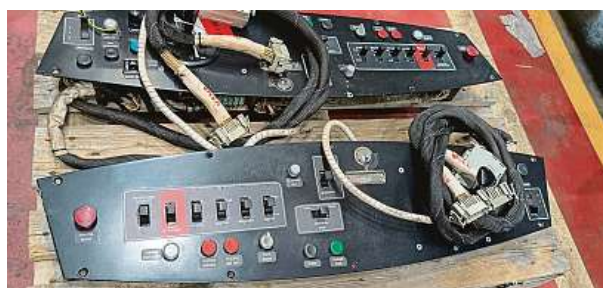
Prohlížíte si řídicí pult vozu M1 čekající na opravářovu péči. Vedle vpravo je „oholený“ sběrač proudu.
