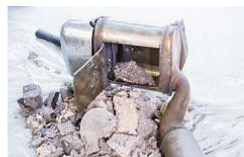
Z DPF testovacího vozu byla odstraněna voštinová keramická vložka s drahými kovy.
