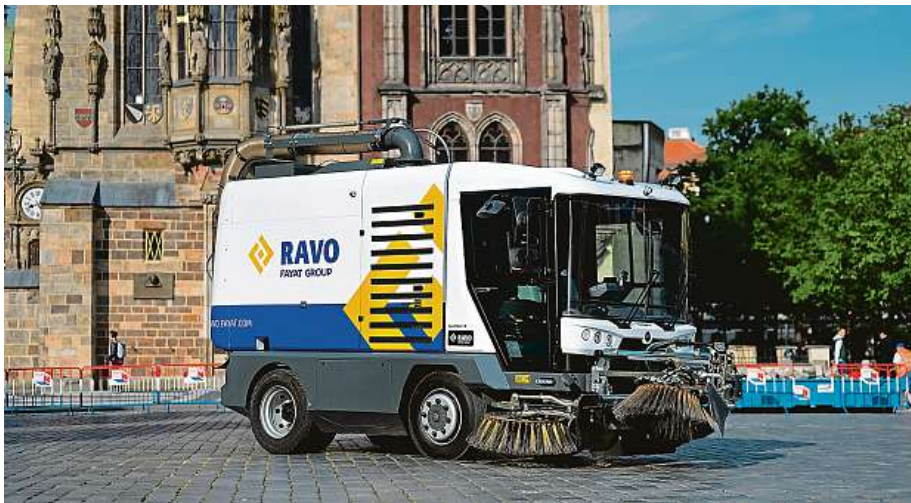
Vůz RAVO 5 eSeries jezdí rychlostí až 40 km/h, má nosnost až 4900 kilogramů a je ideální pro rychlé čištění nádob, mobiliáře či pro vysávání listí a vyprazdňování odpadkových košů.
