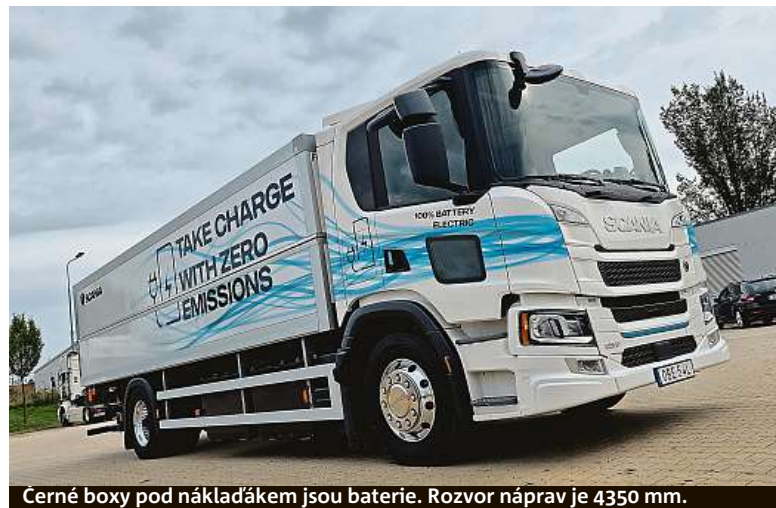
Černé boxy pod nákladákem jsou baterie. Rozvor náprav je 4350 mm.
