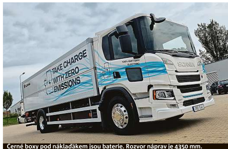
Černé boxy pod nákladákem jsou baterie. Rozvor náprav je 4350 mm.
