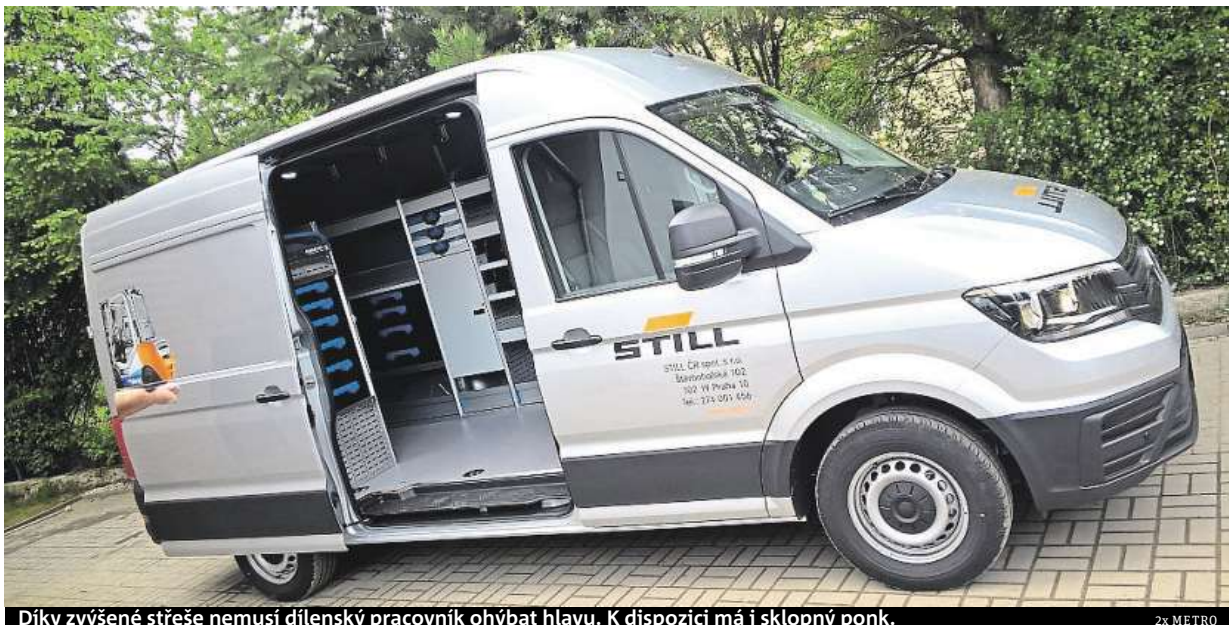
Díky zvýšené střeše nemusí dílenský pracovník ohýbat hlavu. K dispozici má i sklopný ponk.
